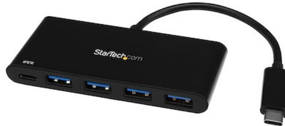
Ce hub USB 3.2 Gen 1 compact vous permet d'ajouter quatre ports USB-A à votre ordinateur portable, et il prend en charge la technologie USB Power Delivery. Cela signifie que vous pouvez alimenter et charger votre ordinateur portable via son port USB-C™ tout en alimentant le hub simultanément.
