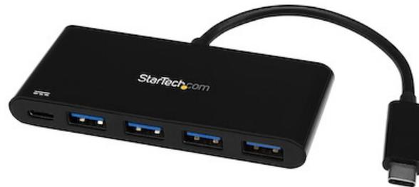
Questo hub USB 3.2 Gen 1 compatto consente di aggiungere quattro porte USB-A al computer laptop, con supporto della tecnologia USB Power Delivery. Questo significa che è possibile alimentare e ricaricare il computer laptop tramite la sua porta USB-C™ alimentando contemporaneamente anche l'hub.
