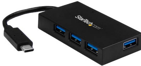
Este compacto concentrador USB 3.2 Gen 1 amplía su conectividad, ya que añade cuatro puertos USB Type-A, a través de un solo puerto USB Type-C™ o Thunderbolt™ 3. Incluye un adaptador de alimentación de 20W, que permite conectar dispositivos USB exigentes, además de poder cargar rápidamente sus dispositivos móviles mediante los puertos USB de carga y sincronización.
