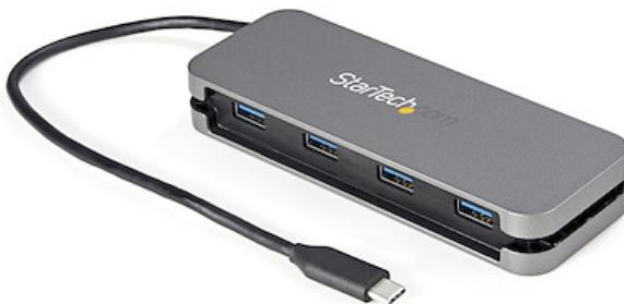
Este concentrador USB-C de 4 puertos le permite conectar cuatro dispositivos periféricos SuperSpeed USB 3.2 Gen 1 (5Gbps) a su ordenador portátil o de sobremesa equipado con USB-C, lo cual constituye una solución ideal para agregar puertos USB a un dispositivo con limitación de puertos USB disponibles. Incluye gestor en espiral de cables, lo cual permite guardar el cable integrado para facilitar la portabilidad.
