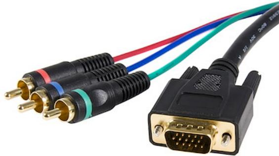
El adaptador para cable HD15 a multiconector de componente RCA (91 cm), modelo HD15CPNTMM3, incluye un conector macho VGA (HD15) y conectores macho de vídeo componente, lo cual permite conectar una salida VGA (tarjeta gráfica, etc.) a una pantalla/monitor que utilice una entrada de vídeo "Component" (componente).
