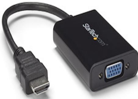
El cable adaptador HDMI® a VGA HD2VGAA2 permite conectar cualquier dispositivo de salida HDMI, como un computador portátil o un extensor de medios digitales a un dispositivo de imagen VGA (monitor, proyector), ya que convierte la señal de video HDMI en una señal de video VGA y en audio análogo de 2 canales.
