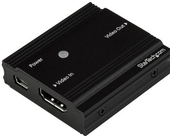
Der 4K-HDMI®-Signalverstärker ermöglicht die Verstärkung der Signalstärke einer HDMI-Videoquelle, sodass eine größere Übertragungsdistanz über Standard-HDMI-Kabel erreicht werden kann. Bei Entfernungen von bis zu 10 m können Sie Auflösungen von bis zu 4K bei 60 Hz erreichen. Abhängig von der gewünschten Auflösung unterstützt der Verstärker Entfernungen bis zu 35 m für Auflösungen von 1080p bei 60 Hz.
