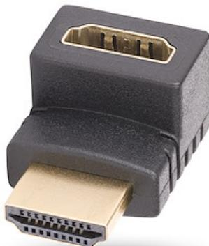
Cet adaptateur HDMI compact avec angle d'inclinaison vers le haut agit comme un sauveur de port, atténuant la contrainte sur les ports et connecteurs HDMI. Idéal pour les installations avec une profondeur limitée, il permet l'accès aux ports HDMI cachés ou orientés vers l'arrière, et réduit l'usure résultante de connexions fréquentes.
