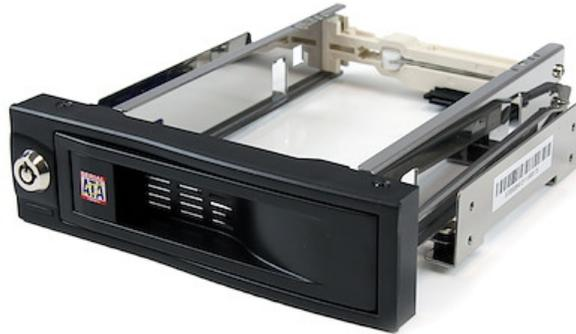
Esta bahía de intercambio en caliente para unidades de disco duro SATA de 3,5" permite instalar una unidad SATA de 3,5" en una bahía de unidad de 5,25" disponible/no utilizada. Para extraer la unidad, basta con abrir la puerta del panel frontal. Asimismo, para reinsertar una unidad, basta con insertarla (primero el conector) hasta que la puerta se cierre.
