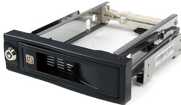
Cette baie de disque dur SATA 3,5 pouces échangeable à chaud vous permet d'installer un disque SATA 3,5 pouces dans une baie de disque 5,25 pouces disponible/inutilisée. Pour retirer le disque, il suffit d'ouvrir la façade avant. Pour réinstaller un disque, il suffit de l'insérer (connecteur vers l'avant) jusqu'à la fermeture de la trappe.
