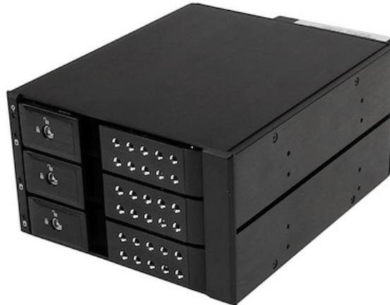
El backplane de 3 unidades extraíbles, modelo HSB3SATSASBA, permite instalar e intercambiar rápidamente unidades de 3,5" de la parte frontal del computador, ya que convierte una bahía de 5,25 pulgadas en una interfaz intercambiable en caliente que permite conectar hasta 3 unidades HDD (de disco duro) SATA o SAS de 3,5".
