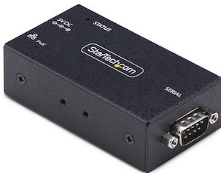
Ce convertisseur série vers IP PoE est une solution efficace pour connecter et contrôler à distance une variété de périphériques série RS232 via un réseau IP. Conforme à la norme PoE 802.3af, l'adaptateur RJ45 LAN vers DB9 permet une intégration transparente des données et de l'alimentation à l'unité via un seul câble en cuivre Cat5/5e/6/6a.
