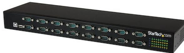
Metodo semplice ed economico per aggiungere una porta seriale RS232 a una configurazione industriale. Questo adattatore da USB seriale a 16 porte è dotato di uno chassis resistente e montabile in rack e supporta la connessione a margherita di più hub, in modo da aumentare il numero delle porte seriali disponibili.
