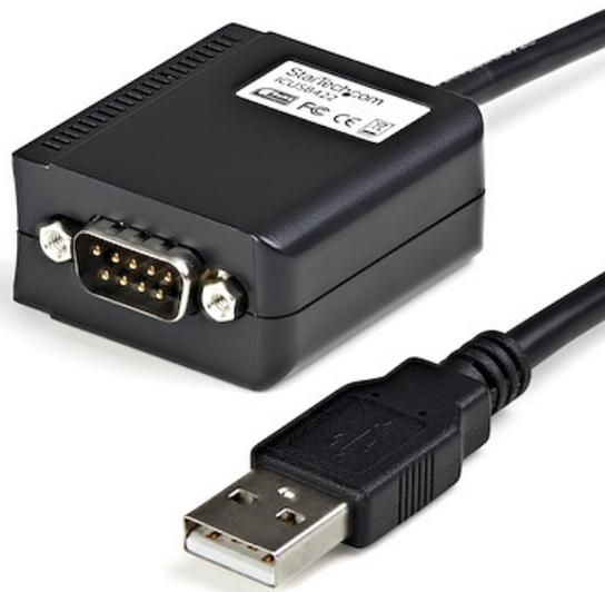
El adaptador de cable serie USB profesional RS422/485 de 1,8 m ICUSB422 con retención de puerto COM le permite conectar dispositivos serie RS422 o RS485 a su ordenador con USB. El adaptador cuenta con un conector serie macho de 9 patillas (DB9), así como controles de conmutador DIP para una fácil configuración de los puertos, y requiere un software mínimo.
