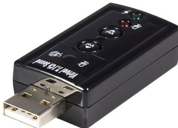
Este adaptador USB a audio permite la conexión de auriculares o altavoces, así como un micrófono, a un ordenador, sin necesidad de desconectar otros dispositivos.
