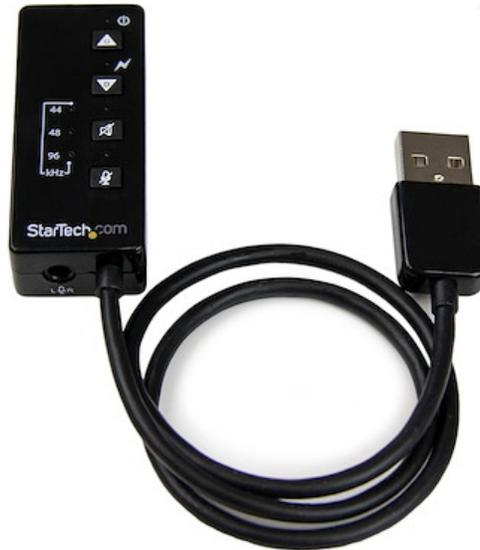
La tarjeta USB externa, modelo ICUSBAUDIOMH, permite agregar a un sistema una salida de audio digital S/PDIF o una conexión de audio análogo estándar de 3,5 mm, a través de USB. Al convertir un solo puerto USB a tarjeta de sonido externa con conectividad para micrófono, es posible evitar el uso de una tarjeta de sonido interna, o bien reemplazarla, sin tener que abrir la caja del ordenador.
