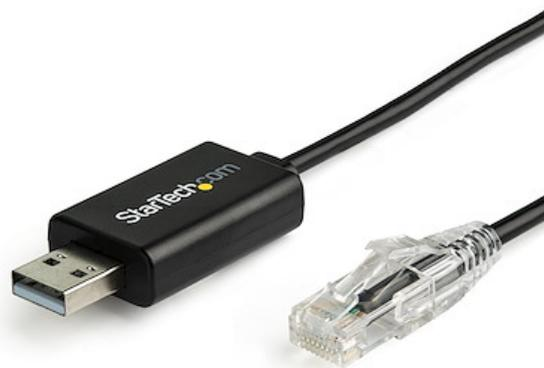
Questo cavo per console USB Cisco offre una connessione affidabile dal computer desktop o laptop alle apparecchiature di rete dotate di porta per console.
