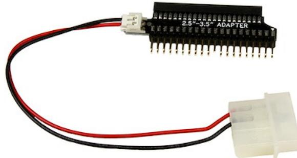
Dieses 2,5-Zoll auf 3,5-Zoll-IDE Festplattenadapterkabel verfügt über eine 44-polige IDE-Buchse und einen 40-poligen IDE-Stecker sowie eine LP4-Stromversorgung. Damit können Sie eine 2,5-Zoll IDE-Laptop-Festplatte an einen Desktopcomputer anschließen.
