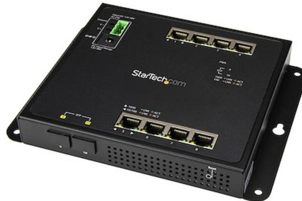
ネットワークの拡張展開が簡単になるギガビットイーサネットスイッチ。8口の銅線ギガビットイーサネット (GbE) ポートと2口の光ファイバSFPスロットを追加する頑丈なスイッチです。
