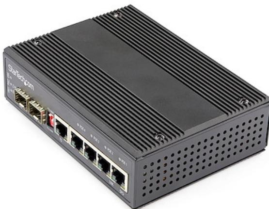
Implemente o ajuste a escala fácilmente su red, mediante este conmutador Ethernet Gigabit, que incluye cuatro puertos PoE+ dedicados habilitados, una ranura SFP abierta dedicada, así como la flexibilidad de un puerto RJ-45/SFP abierto para uso como vínculo superior o para dispositivos no PoE. Incluye caja IP-30, diseño compacto y montaje en pared o mediante carril DIN.
