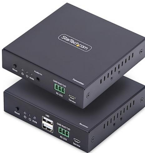
Le prolongateur AVoIP KVM permet un accès à distance à un ordinateur via un réseau TCP/IP avec un clavier, une souris et un moniteur HDMI 4K 60 Hz, garantissant la sécurité des systèmes contre tout accès non autorisé et tout dommage physique.
