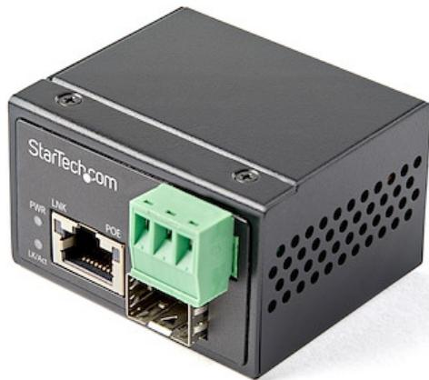
Este conversor de medios SFP PoE por fibra óptica ofrece un método fácil y económico de extender el alcance de la señal de sus dispositivos de datos y alimentación a ubicaciones remotas, mediante su red a través de fibra óptica, con la opción SFP preferida. Combina la conectividad de datos de un conversor de medios con las capacidades flexibles de fuente de alimentación de un inyector PoE.
