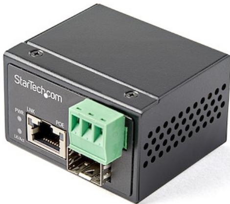
Ce convertisseur de média fibre PoE avec Open SFP constitue un moyen simple et économique d'étendre la portée de vos périphériques de données et d'alimentation à des emplacements distants via votre réseau sur fibre, en utilisant le SFP de votre choix. Il combine la connectivité de données d'un convertisseur de média aux capacités d'alimentation flexibles d'un injecteur PoE.
