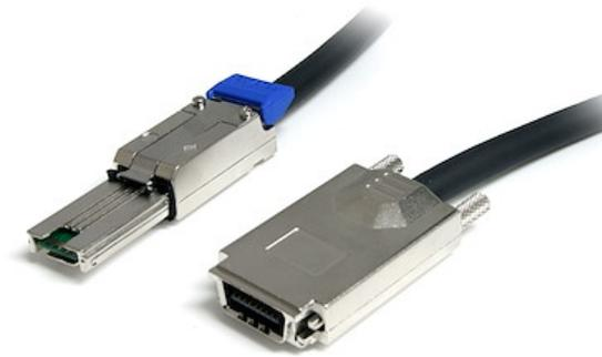
El Cable Serial Attached SCSI de 2 metros, ISAS88702 está diseñado para usar con redes, servidores, estaciones de trabajo y ordenadores de escritorio de alto rendimiento. Este cable SAS dispone de un conector SFF-8470 (Infiniband®) y un conector SFF-8088 (mini-SAS externo), y brinda soporte para velocidades de transferencia de datos de hasta 6 Gbps.
