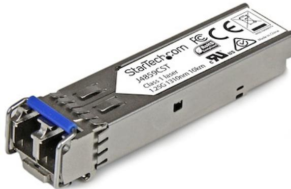
Das J4859CST ist ein HPE J4859C-kompatibles Glasfaser-Transceiver-Modul, das speziell für die Zusammenarbeit mit HPE®-Switches und -Router entwickelt, programmiert und getestet wurde. Es liefert zuverlässige 1-GbE-Konnektivität über Glasfaserkabel für 1000BASE-LX-konforme Netzwerke mit einer maximalen Entfernung von bis zu 10 km.
