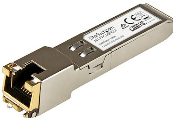
El modelo J8177C10PKST es un paquete de 10 unidades de nuestro módulo transceptor por cobre, compatible con el modelo J8177C de HPE, diseñado, programado y probado para su funcionamiento con enrutadores y conmutadores de la marca HPE®. Ofrece conectividad fiable a 1GbE a través de cableado de cobre, para redes compatibles con 1000BASE-T, a una distancia máxima de hasta 100m.
