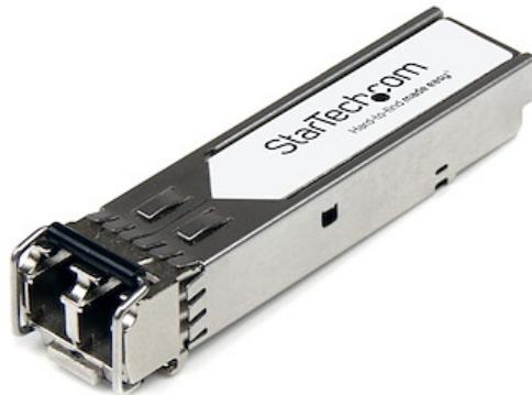
Le J9150A-ST est un module de transceiver SFP+ fibre optique compatible HPE J9150A qui a été conçu, programmé et testé pour fonctionner avec des commutateurs et des routeurs de marque HPE®. Il vous assure une connectivité de 10 GbE par câble en fibre optique, sur les réseaux compatibles 10GBASE-SR et sur une distance maximale de 300 m.
