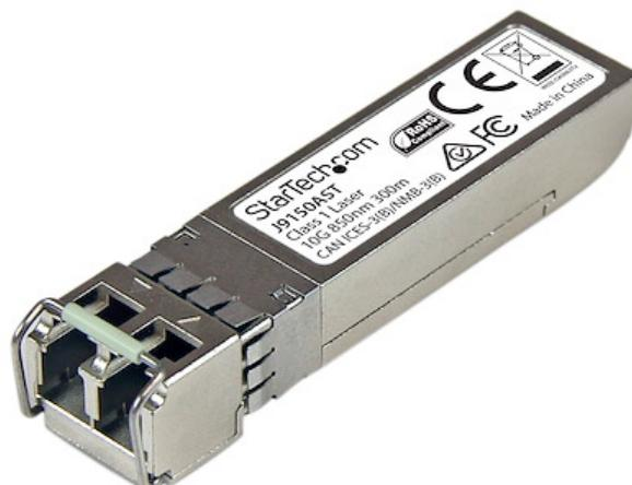
El modelo J9150AST es un módulo transceptor por fibra óptica, compatible con el modelo J9150A de HPE, diseñado, programado y probado para su funcionamiento con enrutadores y commutadores de la marca HPE®. Ofrece conectividad fiable a 10GbE a través de cableado de fibra, para redes compatibles con 10GBASE-SR, a una distancia máxima de hasta 300m.
