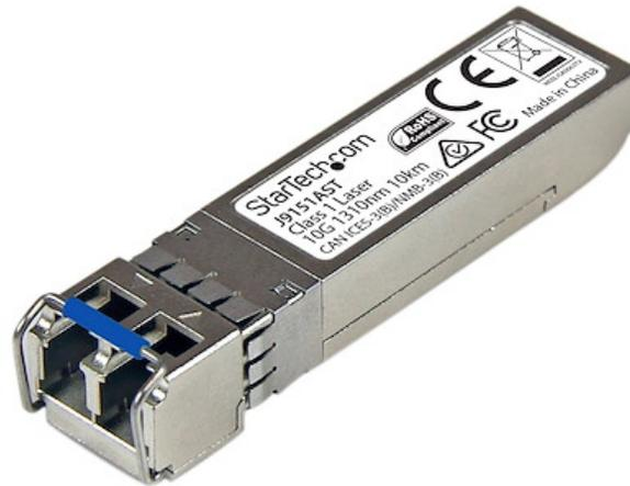
Das J9151AST ist ein HPE J9151A-kompatibles Glasfaser-Transceiver-Modul, das speziell für die Zusammenarbeit mit HPE®-Switches und -Router entwickelt, programmiert und getestet wurde. Es liefert zuverlässige 10-GbE-Konnektivität über Glasfaserkabel für 10GBASE-LR-konforme Netzwerke mit einer maximalen Entfernung von bis zu 10 km.
