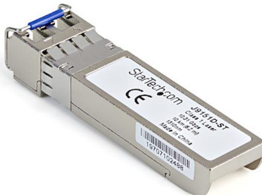
El modelo J9151D-ST es un módulo transceptor SFP+ por fibra óptica compatible con el modelo J9151D de HPE diseñado, programado y probado para su funcionamiento con routers y switches de la marca HPE®. Ofrece conectividad fiable a 10 GbE, a través de cable de fibra óptica, para redes compatibles con 10GBASE-LR, a una distancia máxima de hasta 10 km.
