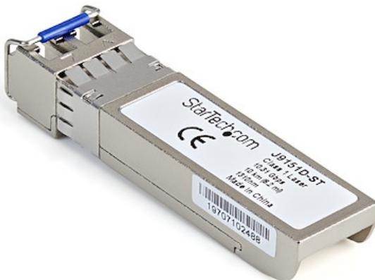
Le J9151D-ST est un module de transceiver SFP+ fibre optique compatible HPE J9151D qui a été conçu, programmé et testé pour fonctionner avec des commutateurs et des routeurs de marque HPE®. Il vous assure une connectivité de 10 GbE par câble en fibre optique, sur les réseaux compatibles 10GBASE-LR et sur une distance maximale de 10 km.
