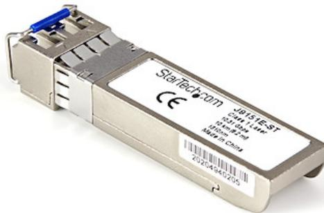
Der J9151E-ST ist ein HPE J9151E-kompatibles Glasfaser SFP+-Transceiver-Modul, das für den Einsatz mit HPE® Marken-Switches und -Routern entwickelt, programmiert und getestet wurde. Es sorgt für zuverlässige 10 GbE-Konnektivität über Glasfaser-Kabel für 10GBASE-LR-konforme Netzwerke mit einer maximalen Entfernung von bis zu 10 Km.
