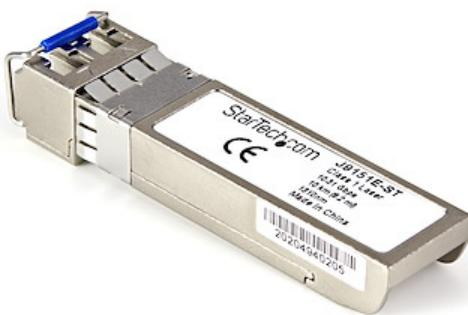
El modelo J9151E-ST es un módulo transceptor SFP+ por fibra óptica compatible con el modelo J9151E de HPE diseñado, programado y probado para su funcionamiento con routers y switches de la marca HPE®. Ofrece conectividad fiable a 10GbE, a través de cable de fibra óptica, para redes compatibles con 10GBASE-LR, a una distancia máxima de hasta 10 Km.
