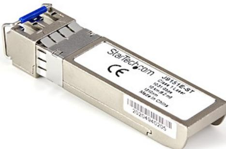
Le J9151E-ST est un module de transceiver SFP+ fibre optique compatible HPE J9151E qui a été conçu, programmé et testé pour fonctionner avec des commutateurs et des routeurs de marque HPE®. Il vous assure une connectivité de 10 GbE par câble en fibre optique, sur les réseaux compatibles 10GBASE-LR et sur une distance maximale de 10 Km.
