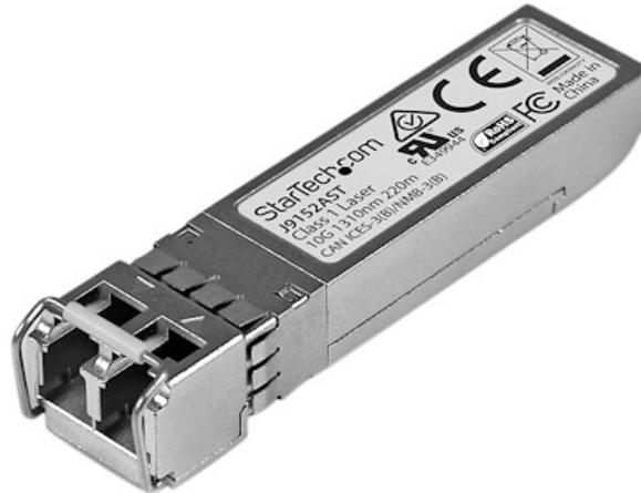
Il prodotto J9152AST è un modulo ricetrasmittitore per fibra compatibile con HPE J9152A, progettato, programmato e testato per operare con switch e router a marchio HPE®. Offre un'affidabile connettività da 10 GbE tramite cavo in fibra per le reti compatibili con 10GBASE-LRM, a una distanza massima di 220 m.
