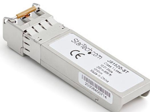
El modelo J9152D-ST es un módulo transceptor SFP+ por fibra óptica compatible con el modelo J9152D de HPE diseñado, programado y probado para su funcionamiento con routers y switches de la marca HPE®. Ofrece conectividad fiable a 10 GbE, a través de cable de fibra óptica, para redes compatibles con 10GBASE-LRM, a una distancia máxima de hasta 200 m.
