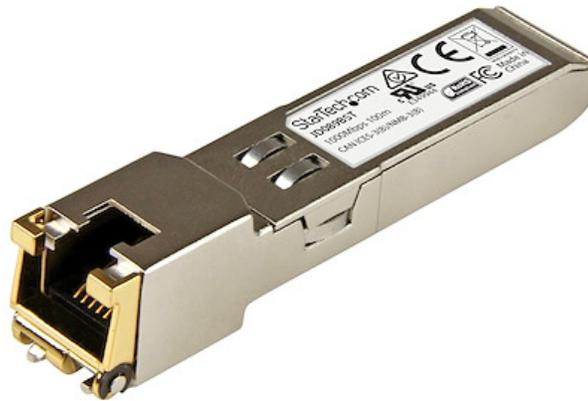
El modelo JD089BST es un módulo transceptor por cobre, compatible con el modelo JD089B de HPE, diseñado, programado y probado para su funcionamiento con enrutadores y conmutadores de la marca HPE®. Ofrece conectividad fiable a 1GbE a través de cableado de fibra, para redes compatibles con 1000BASE-T, a una distancia máxima de hasta 100m.
