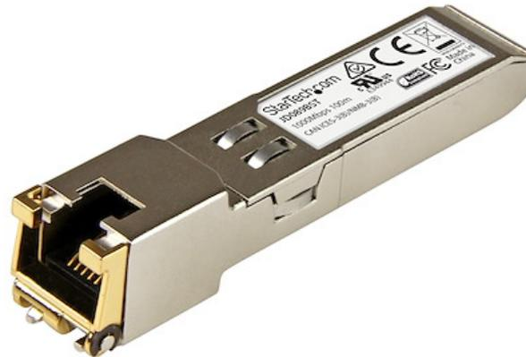
Le modèle JD089BST est un module de transceiver en cuivre compatible avec HPE JD089B, qui a été conçu, programmé et testé pour fonctionner avec les commutateurs et routeurs de la marque HPE®. Il fournit une connectivité 1 GbE fiable sur câble à fibre optique pour les réseaux conformes aux spécifications 1000BASE-T, avec une distance maximale de 100 m.
