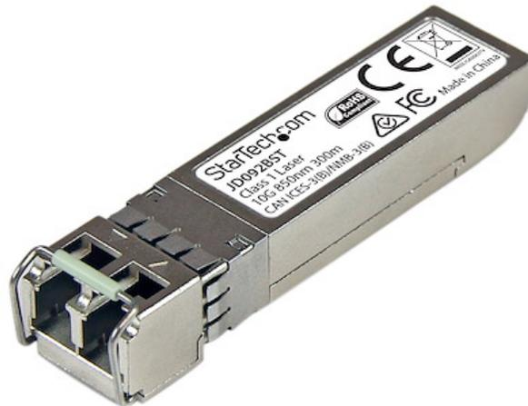
Le modèle JD092BST est un module de transceiver à fibre optique compatible avec HPE JD092B, qui a été conçu, programmé et testé pour fonctionner avec les commutateurs et routeurs de la marque HPE®. Il fournit une connectivité 10 GbE fiable sur câble à fibre optique pour les réseaux conformes aux spécifications 10GBASE-SR, avec une distance maximale de 300 m.
