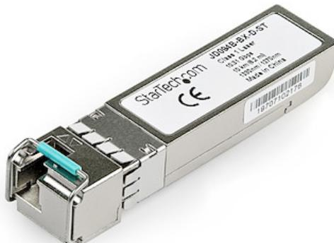
Le JD094B-BX-D-ST est un transceiver SFP+ fibre optique en aval compatible HPE JD094B-BX-D qui fonctionne avec JD094B-BX-U de StarTech.com. Ils sont conçus, programmés et testés pour fonctionner avec des commutateurs et des routeurs compatibles avec les normes MSA 10GBASE-BX. Le module de transceiver SFP+ fonctionne jusqu'à une distance de 10 km et vous assure une connectivité de 10 GbE par câblage optique.
