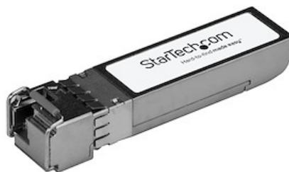
Le JD094B-BX40-D-ST est un transceiver SFP+ fibre optique en aval compatible HPE JD094B-BX40-D qui fonctionne avec JD094B-BX40-U-ST de StarTech.com. Ils sont conçus, programmés et testés pour fonctionner avec des commutateurs et des routeurs compatibles avec les normes MSA 10GBASE-BX. Le module de transceiver SFP+ fonctionne jusqu'à une distance de 40 km et vous assure une connectivité de 10 GbE par câblage optique.
