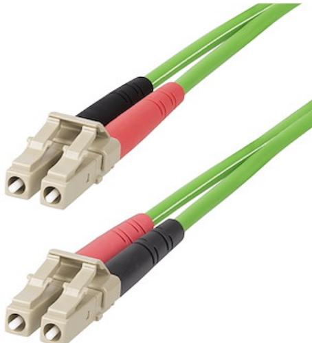
Le câble de raccordement à fibres optiques duplex multimode OM5 LC vers LC facilite la connectivité sur les réseaux 40G et 100G. Il prend en charge la SWDM (Multiplexage en Division de Longueur d'Onde en Ondes Courtes) sur une plage de longueurs d'onde étendue de 850 à 953 nm VCSEL, améliorant la qualité du signal et la capacité de performance par rapport à l'OM4.
