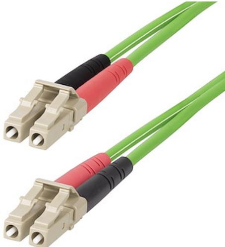
Le câble à fibres optiques duplex multimode OM5 LC vers LC facilite la connectivité sur les réseaux 40G et 100G. Il prend en charge la SWDM (Multiplexage par Division de Longueur d'Onde à Onde Courte) sur une plage de longueurs d'onde étendue de 850 à 953 nm avec VCSEL, améliorant la qualité du signal et la capacité de performance par rapport à l'OM4.
