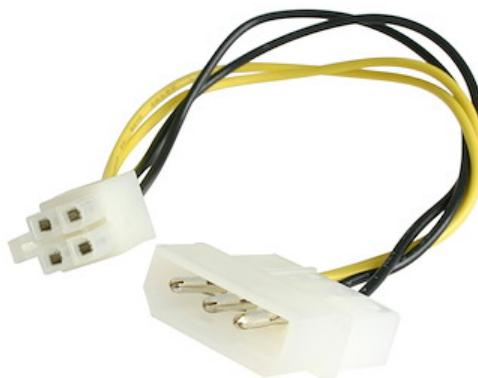
Este adaptador de cable de alimentación auxiliar LP4 a P4 de 15cm convierte un conector LP4 hembra en un conector P4 macho, necesario para conectar a una placa base Pentium 4.
