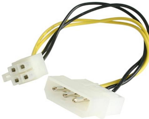
Questo cavo adattatore di alimentazione ausiliario da LP4 a P4 da 15 cm trasforma un connettore LP4 femmina nel connettore P4 maschio necessario per il collegamento a una scheda madre Pentium 4.
