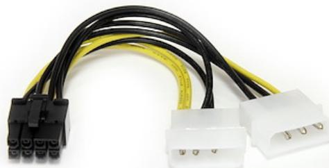
El Adaptador de Alimentación LP4 a PCI Express de 8 Pines de 6 pulgadas, LP4PCIEX8ADP permite convertir un conector de alimentación estándar LP4 de una fuente de alimentación existente en un conector de tarjeta de vídeo PCI Express de 8 pines, haciendo posible la instalación de una tarjeta gráfica PCIe sin tener que actualizar la fuente de alimentación.
