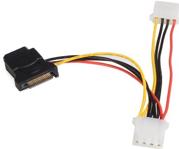
El Cable de Alimentación SATA a LP4, LP4SATAFM2L permite alimentar una unidad IDE (conexión LP4) usando un conector de alimentación SATA desde la fuente de alimentación del ordenador. El adaptador dispone de dos conectores de alimentación LP4 adicionales, proporcionando versatilidad para conectar dos unidades (CD/DVD-ROM, HDD, etc.) adicionales (conexión LP4 ) empleando la misma conexión a la fuente de alimentación del ordenador.
