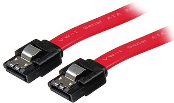
El cable SATA LSATA24 cuenta con dos receptáculos de datos de 7 pines con enganche y admite un ancho de banda completo SATA 3.0 de hasta 6 Gbps cuando se usa con unidades compatibles con SATA 3.0.
