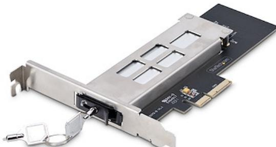
Utilice una ranura de expansión PCIe 4.0 x4 disponible para la instalación, extracción o intercambio de unidades SSD PCIe M.2. La bandeja para unidades admite unidades SSD M-Key M.2 NVMe de los tamaños 2230, 2242, 2260 y 2280.
