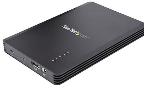
Mit diesem Thunderbolt™ 3 auf 4x M.2 PCIe SSD Gehäuse können Sie vier M-Key PCI Express basierte M.2 NVMe oder AHCI Solid State Drives (SSDs) in eine externe Speicherlösung mit hoher Leistungsfähigkeit verwandeln.
